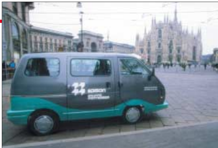
Furgone Carica, dotato di batteria zinco-aria da 75 kWh
